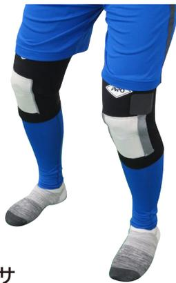
導電糸と絶縁糸の組合せ構造により実現した織物で出来たセンサです。織物の伸びを検出する「伸縮シリーズ」と、織物に加わる圧力を検出する「圧力分布シリーズ」があります。センサで検出した信号は無線通信でパソコン等に送信することで、リアルタイムでの信号の変化を確認することが出来ます。
